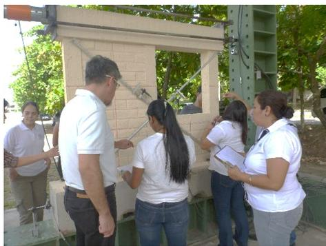
(枠組組積造壁の水平載荷実験)
